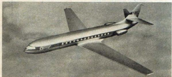
L'industrie aéronautique française produira prochainement un biréacteur moyen courrier susceptible de remplacer le Comet, le S.E.210 « Caravelle ». Muni de deux réacteurs Rolls-Royce, cet appareil volera à 12.000 mètres d'altitude, à 730 km.-heure. Les réacteurs, pour la première fois, sont placés en nacelle, à l'extrémité arrière du fuselage.
